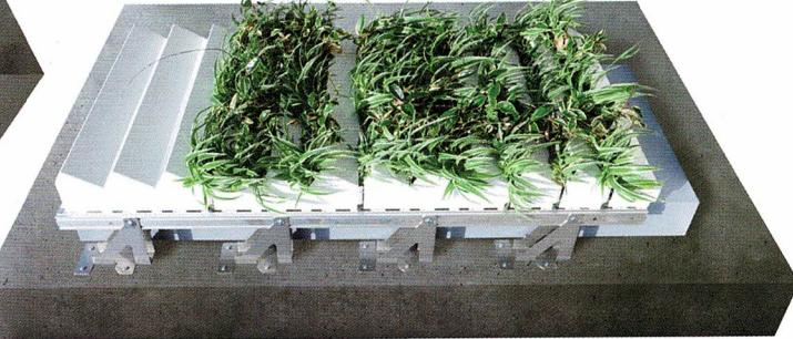
Auf die zusätzlich angeklebte Diffusionsschicht folgt in diesem Falle aber kein Panel, wie es bei vorgehängten Fassaden sonst der Fall ist, sondern eine passende Pflanzkassette. Diese wird direkt in die Unterkonstruktion eingehakt und bedeckt die darunterliegende Dämmung vollflächig.
